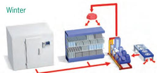
Die benötigte Heizleistung wird der Abwärme der Gewerbekälte entnommen. Überschüssige Abwärme wird nach außen geführt. Ist die Abwärmeleistung nicht ausreichend, wird in seltenen Fällen die Wärmepumpenfunktion zugeschaltet.
