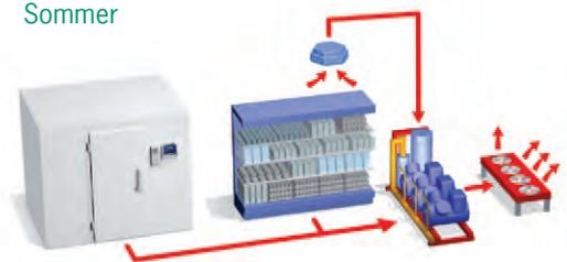
Zur Kühlung kann neben der Gewerbekälte optional eine Klimatisierung eingesetzt werden. Deren Abwärmemenge wird nach außen geführt.
