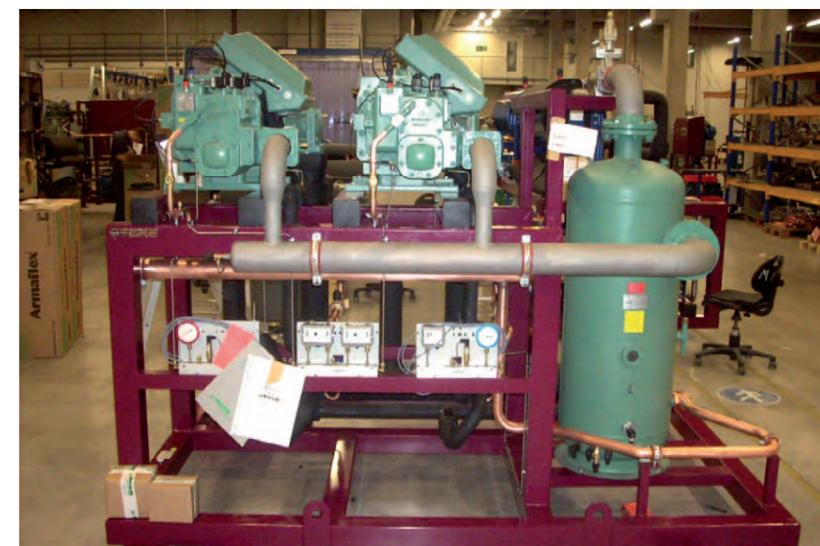
Der Tiefkühlkältebedarf wird mit einer 4-stufigen Verbundmaschine der TEKOPACK-Serie 6000 (TPS4 – 4 VHC-10K) abgedeckt. Die Kälteleistung am Maschinensatz beträgt 218 kW nach den vorgegebenen Bedingungen. Um die Montage und Installation erheblich zu vereinfachen, ist der „Kaskaden-Verdampfer-Verflüssiger“ auf dem Gestell dieser Maschine aufgebaut.
