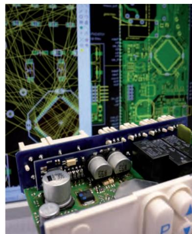
Der Prozessor bildet die Basis des Reglers. Die Verwendung einer vorhandenen Prozessorfamilie kann die Entwicklungszeit deutlich verkürzen. Zusätzlich prüfen die Mitarbeiter, ob vorhandene Gehäuse oder Bauteile einsetzbar sind. Gleiche Bauelemente in mehreren Produkten sichern marktgerechte Preise und vereinfachen die Materialdisposition. Dies hat einen positiven Effekt auf die Lieferzeiten.
