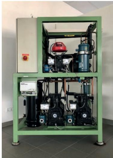
Nicht zuletzt wegen der geringen Aufstellfläche von nur 1,5 m<sup>2</sup> wurde der DISCPACK1 bei Penny in Serie eingesetzt. Die Maschine in Unterliederbach lief 25 Jahre nahezu störungsfrei. Auch für TEKO hat sich durch dieses Projekt grundlegend etwas verändert: Wir starteten mit der Entwicklung von optimierten Kältesystemen, zugeschnitten auf die Bedürfnisse des Lebensmitteleinzelhandels –
