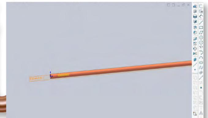
4. Erstellung der Schneiddaten via automatisch erzeugten Step-Modell.
