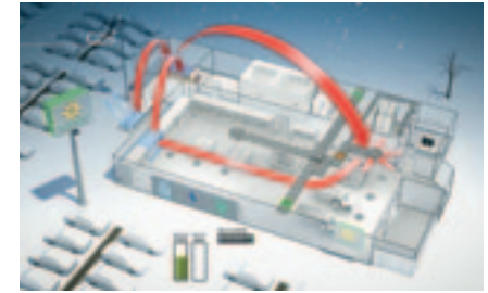
Höchstmögliche Energieeffizienz durch Nutzung der Abwärme aus der Gewerbekälte
